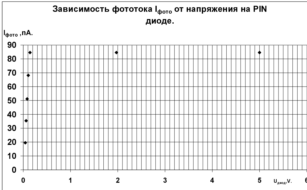
Рис. 6: Фототок от напряжения для PIN PD серии S2744-08 5B3.
