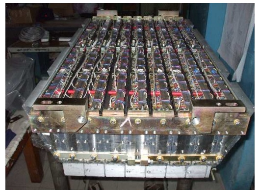
Рис. 4.32. Слева показан стандартный октант, готовый к установке на детектор. Справа – специальный октант, крышки всех модулей сняты.
